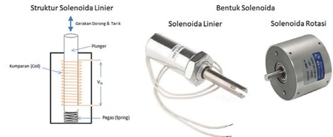
Gambar 10. Struktur dan bentuk solenoida
