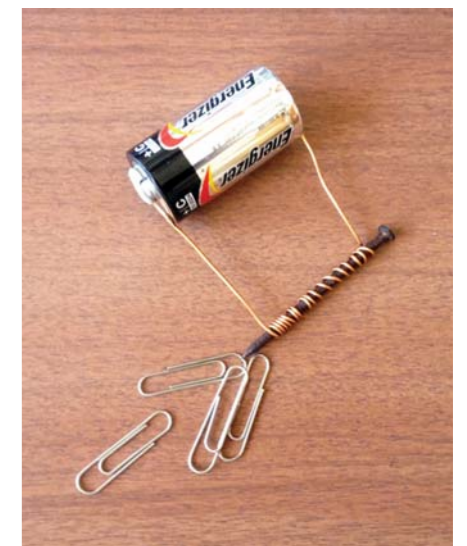
Gambar 4. Membuat magnet dengan cara elektromagnetik
